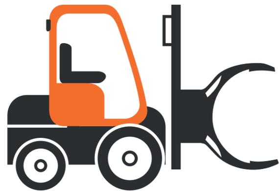
**Grúa horquilla con tenazas** para levantar elementos sobredimensionados como rollos de papel y troncos de madera
