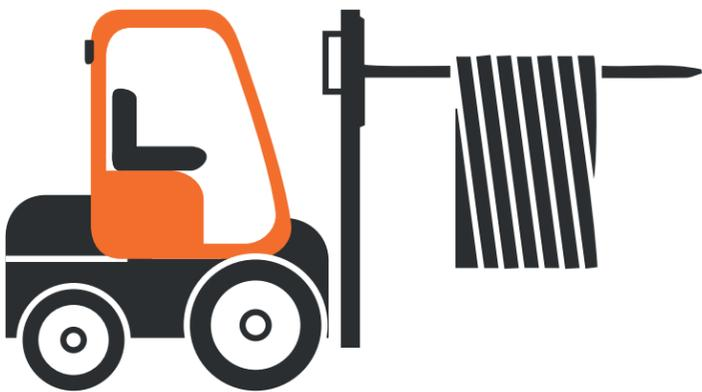
**Grúa horquilla con lanza** para levantar elementos sobredimensionados como bobinas de acero y rollos de alambre
