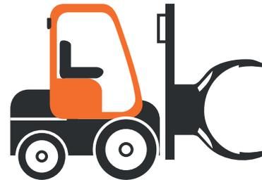
**Grúa horquilla con tenazas** para levantar elementos sobredimensionados como rollos de papel y troncos de madera
