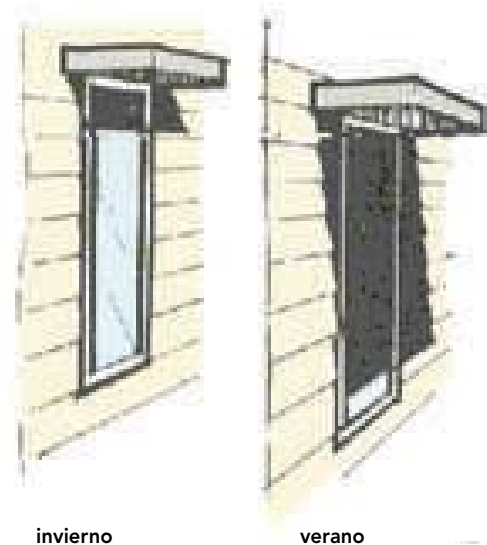
Figura 13 – 31: Protección solar fija, instalación de aleros sobre las ventanas, entregando la sombra según la estación.
