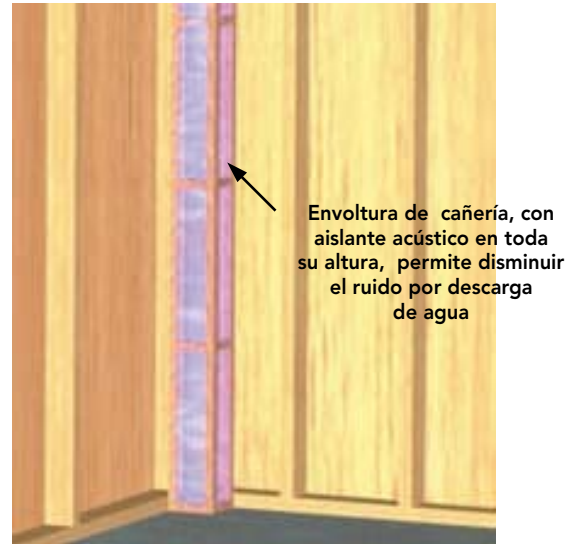
Figura 16-14: Cañería envuelta con lana de vidrio papel una cara.
