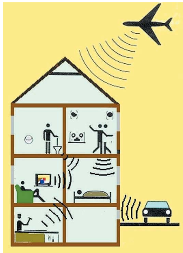
Figura 14 – 60 : Transferencias de sonido al interior de una vivienda.
