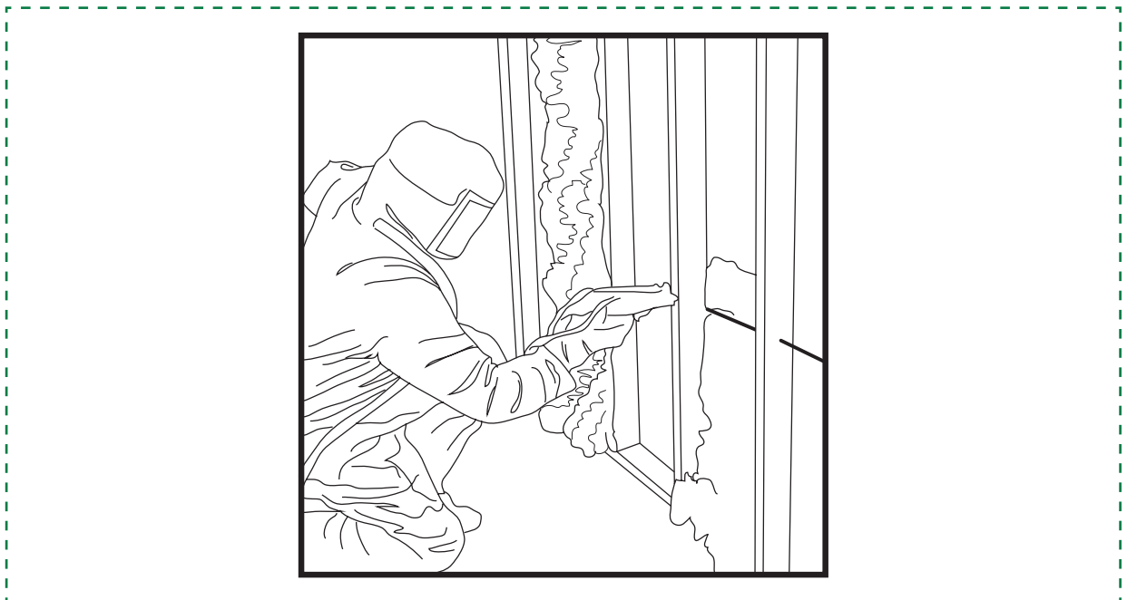
Figura 40. Aplicación de poliuretano
