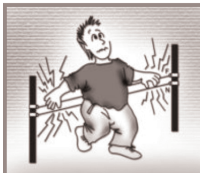
Se produce un contacto directo cuando una persona toca la parte de una instalación eléctrica que está bajo potencial eléctrico; por ejemplo: un conductor desnudo, un borne metálico, un casquillo portalámparas, etc.
