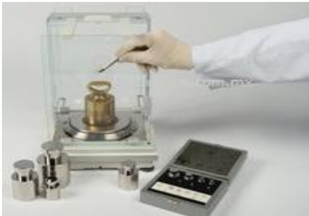
Calibración de una balanza electrónica.
