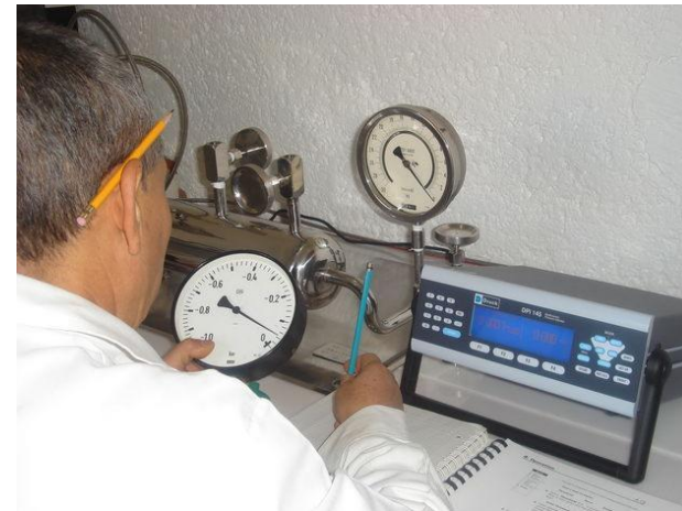
Calibración de un manómetro con un manómetro patrón.
