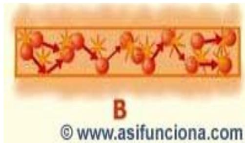
B.- Electrones fluyendo por un mal conductor eléctrico, que ofrece alta **resistencia** a su paso. En ese caso los electrones chocan unos contra otros al no poder circular libremente y, como consecuencia, **generan calor**.
