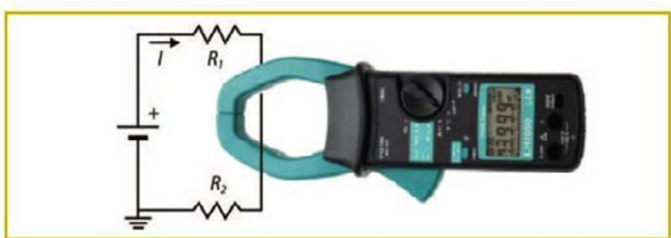
Figura 3. Medición de intensidad con amperímetro de tenaza.
