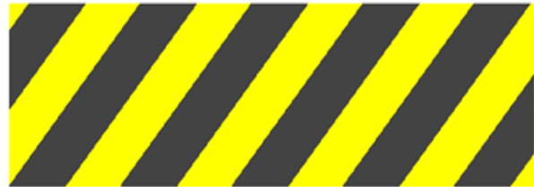
Combinación de color: amarillo y negro de contraste Franjas de seguridad para indicar zonas de peligro
