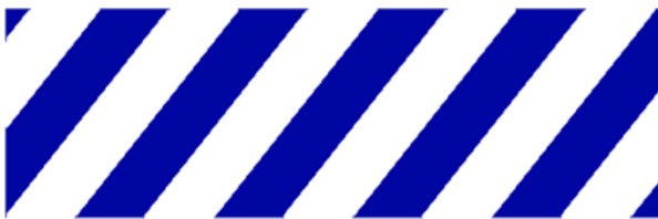
Combinación de color: azul y blanco de contraste Franjas de seguridad para indicar una instrucción obligatoria
