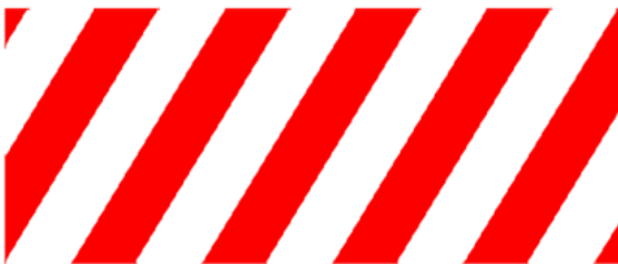
Combinación de color: rojo y blanco de contraste Franjas de seguridad para indicar prohibición o zona de lucha contra incendios
