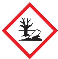
Peligroso para el medioambiente
