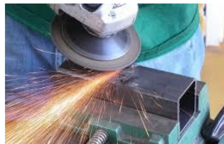
Fig. 1 Esmerilado de una pieza metálica.
